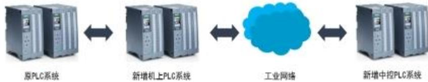
图 4.13 改造后 PLC 远程通信子系统
