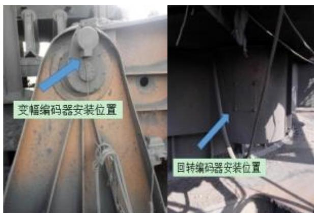
图 2.20 设备回转和俯仰编码器暗转位置示意图
