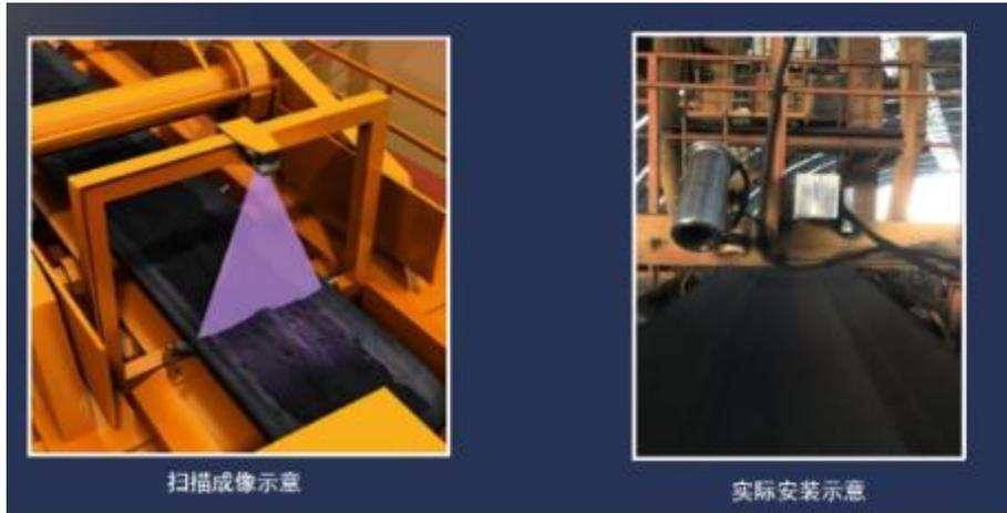
图 4.10 料流量激光雷达现场安装图
