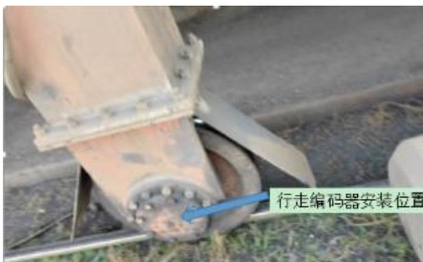
图 2.19 行走编码器安装位置示意图
