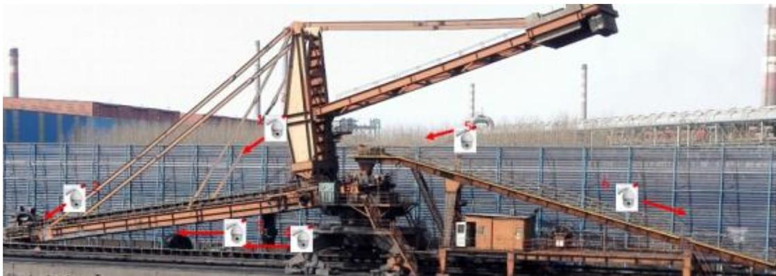
图 2.14 堆取料机视频监控安装示意图
