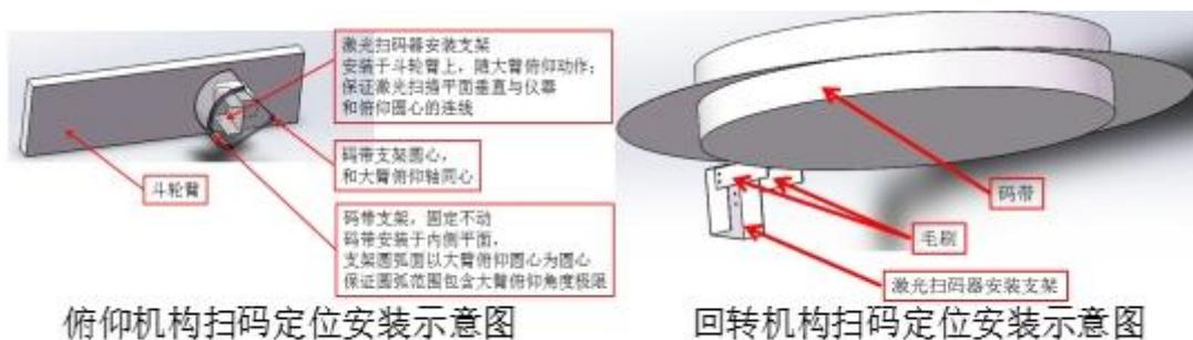
图 2.23 扫码定位安装示意图
