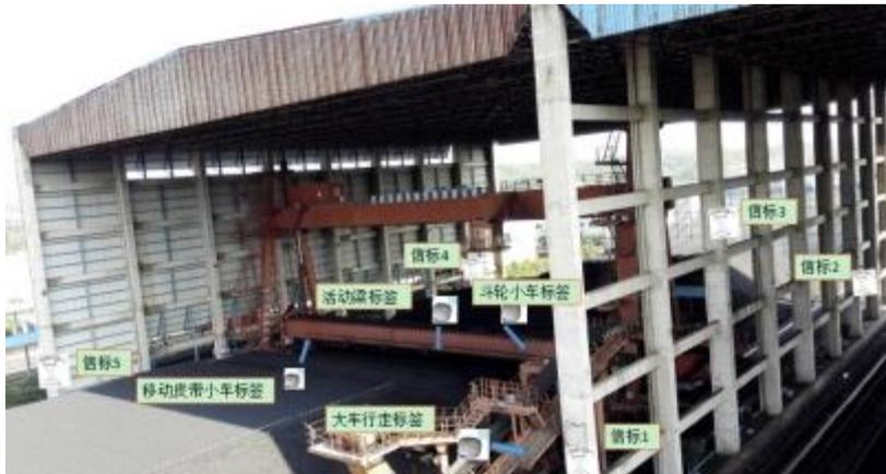
图 2.26 UWB 系统安装位置示意图
