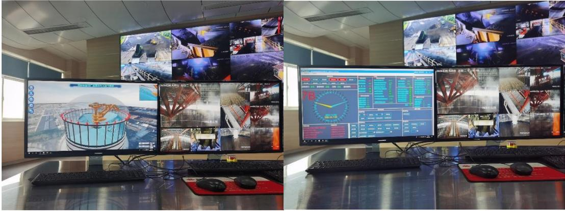
图 4.6 堆取料作业操作界面
